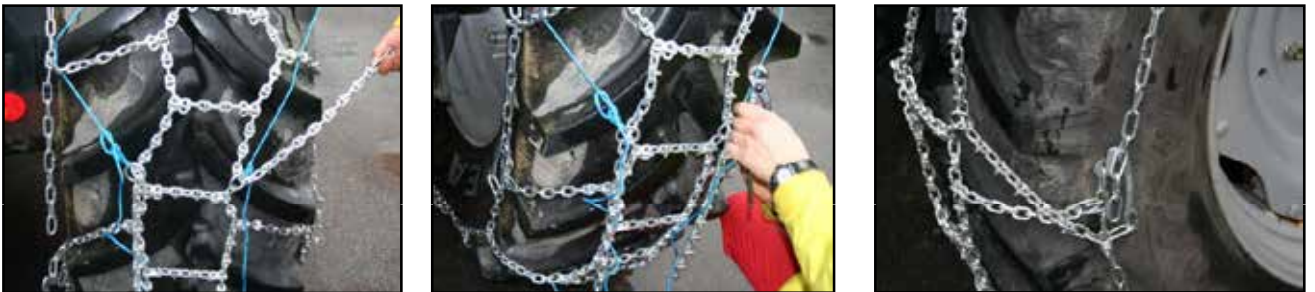
Stopp traktoren når kjettingendene møtes og fest låsearmene i sidekjettingene på hver side. For endelenkene gjennom ringene på hver side og ned i sidekjettingene Husk å kutte sidekjettinglenker som er for lange og å skru sjaklene ned i sidekjettingen godt fast.
