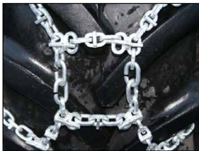
Stopp traktoren når kjettingene møtes og frigjør kransen av skråskjærte koblingslenker. Koble sammen de skråskjærte koblingslenkene på hver side som vist.
