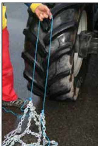
Fest et et tau på hver side av koblingslenkene, heng tauet i traktorribbene som vist.
