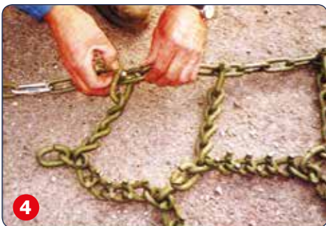
4 Monter sjaklene fra seksjonen til sidekjettingene.
