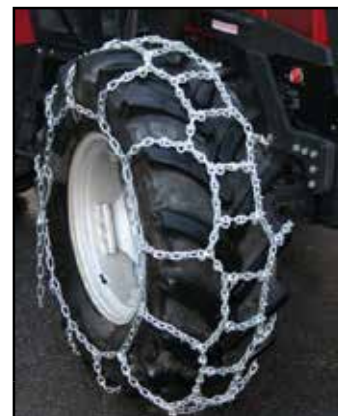
Fest siste nedtak til sidekjettingene på hverside med sjakel. Lilleseeth Lettkjettikjetting 7mm ferdig montert. Husk å skru sjaklene godt til før kjøring
