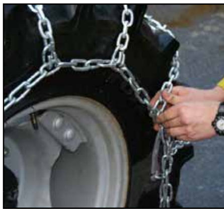
Fest siste nedtak til sidekjettingene på hverside med sjakel. Lilleseeth Lettkjettikjetting 7mm ferdig montert. Husk å skru sjaklene godt til før kjøring
