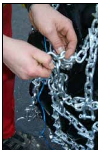
Stopp traktoren når kjettingene møtes og frigjør kransen av skråskjærte koblingslenker. Koble sammen de skråskjærte koblingslenkene på hver side som vist.
