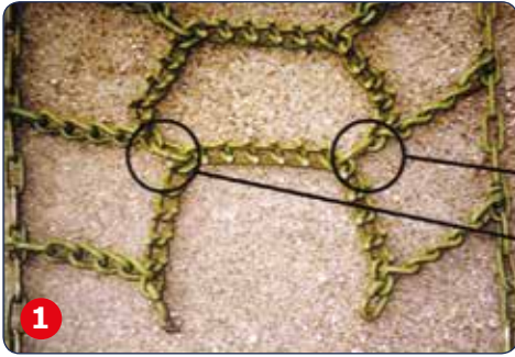
1 Komplettraktorkjetting med koblingslenker før nedkorting.
