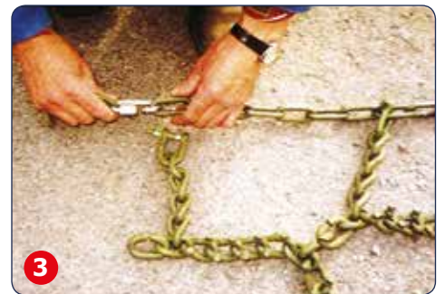
3 Monter inn sidekjettingbitene med kvikk linker.
