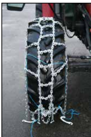
Stopp traktoren når kjettingene møtes og frigjør kransen av skråskjærte koblingslenker. Koble sammen de skråskjærte koblingslenkene på hver side som vist.
