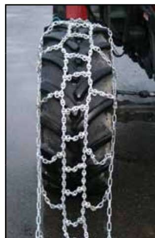
Kjør kjetting sakte på hjulet
