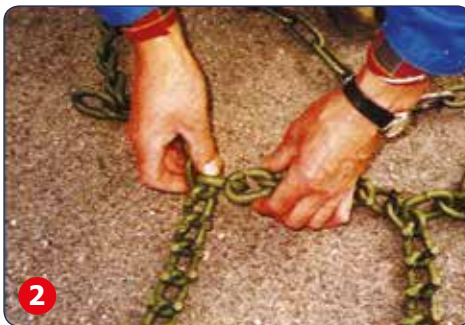
2 Monter sammen koblingslenkene på hver side.
