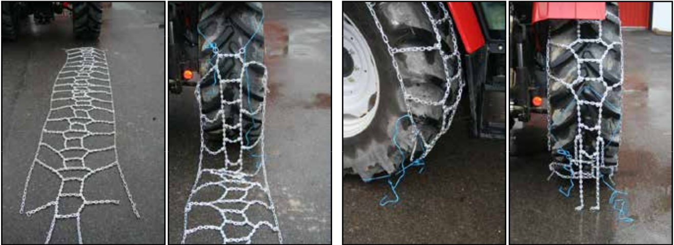
Legg ut kjettingen med broddene opp Fest et tau i de to ringene i enden av kjettingen og heng tauet i traktorribbene som vist. Kjør kjetting sakte på hjulet
