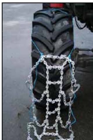
Fest et et tau på hver side av koblingslenkene, heng tauet i traktorribbene som vist.
