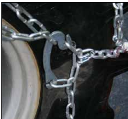
Stram kjettingene på hver side med låsearmene som vist. Husk å kutte sidekjettinglenker som er for lange
