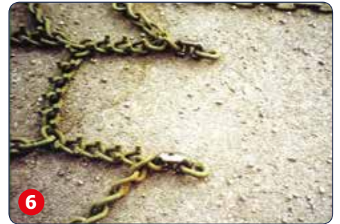
6 En enkel og grei nedkorting av en kjetting som er for lang med stiftkoblinger og OFA koblingslenker.
