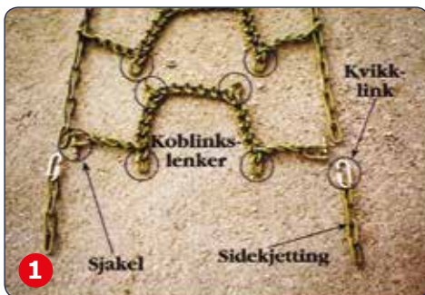
1 Komplette forlengingssats til, i dette tilfellet OFA-traktorkjettinger, består av ett stykk seksjon med koblingslenker i begge ender, pluss to stykker sidekjettingbiter og to stykker kvikk link.
